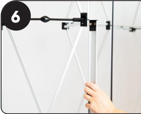
6 Befestigen Sie die Magnete am Rahmen. Die langen Streifen sind für die Unterseite, die kürzeren für die Mitte und Oberseite. Es ist wichtig zu beachten, dass die Streifen richtig montiert werden, ansonsten passt der Druck nicht auf das System. Die Platten selbst sind schon mit den entsprechenden Magneten ausgestattet.
